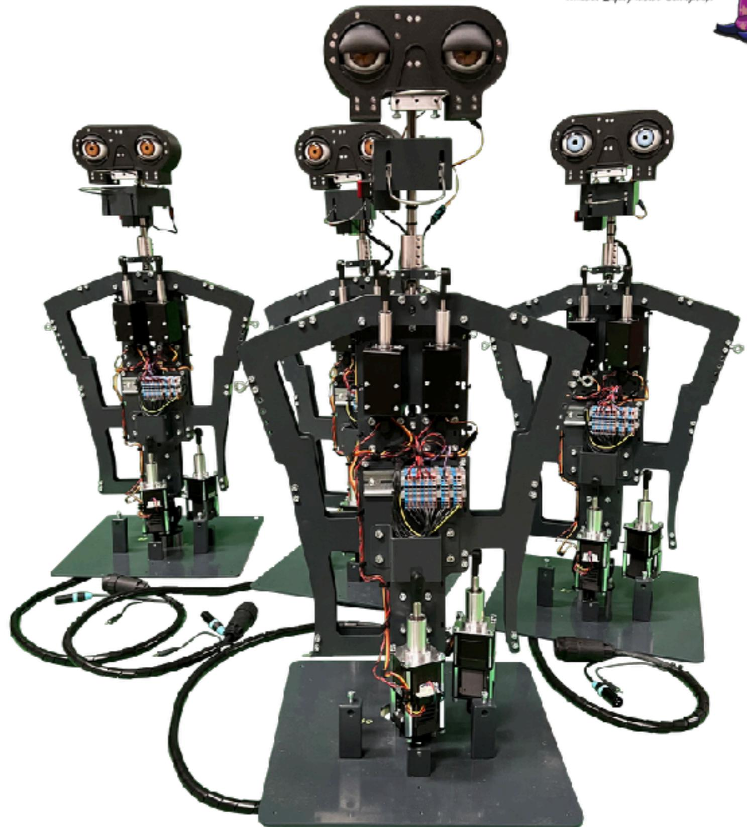
Die technische Grundkonstruktion der Sesselanimateure wird mit modernen Fertigungstechniken hergestellt. Laser und 3D Produktionsverfahren werden eingesetzt.
